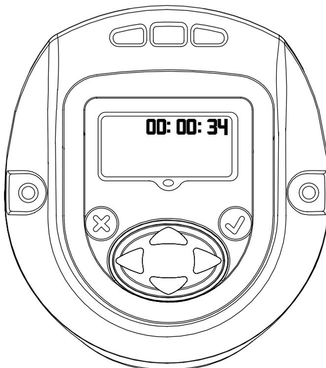
Viser verktøytid i TT:MM:SS-format. Trykk Ned-tasten for å vise verktøytid i formatet TT:MM:SS.
