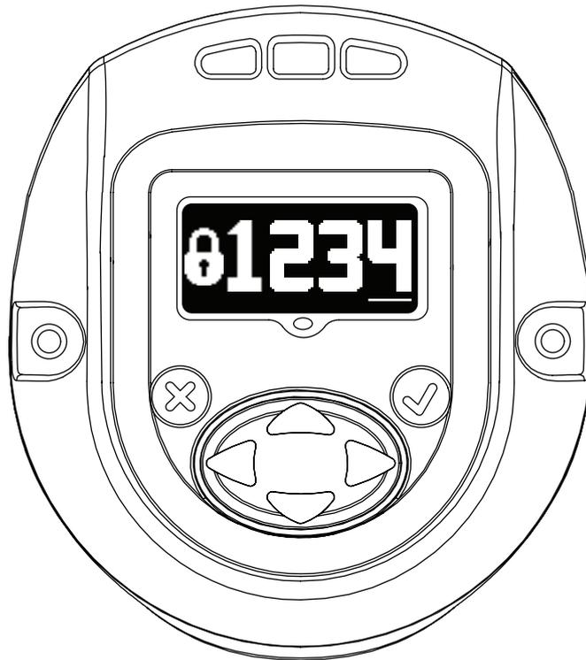
Om "1234" skrivs in på lösenordsskärmen kan användaren använda den vänstra pilen till att gå till verktygs-ID och sidan med programvaruversion.
