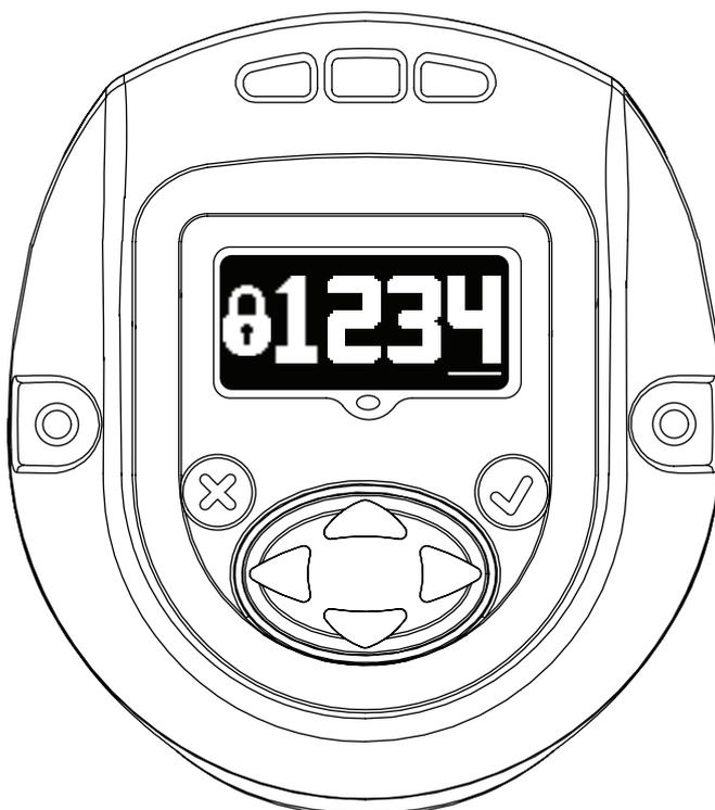
После ввода на экране пароля комбинации 1234 пользователь может с помощью кнопки со стрелкой влево перейти к страницам идентификационного номера инструмента и версии программного обеспечения
