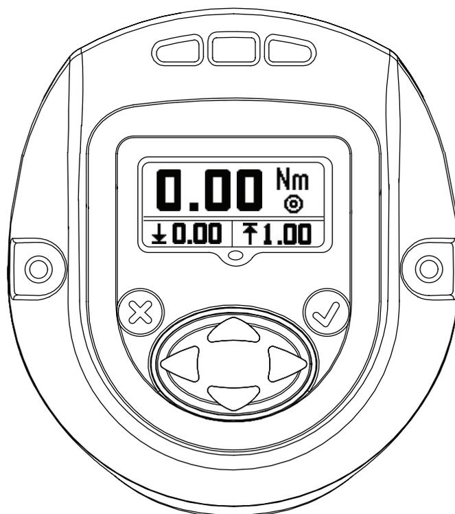
Spustelėjus AUKŠTYN, grįžtama į RUN SCREEN (Paleidimo ekraną) – pirmąjį monitoriaus ekraną.
