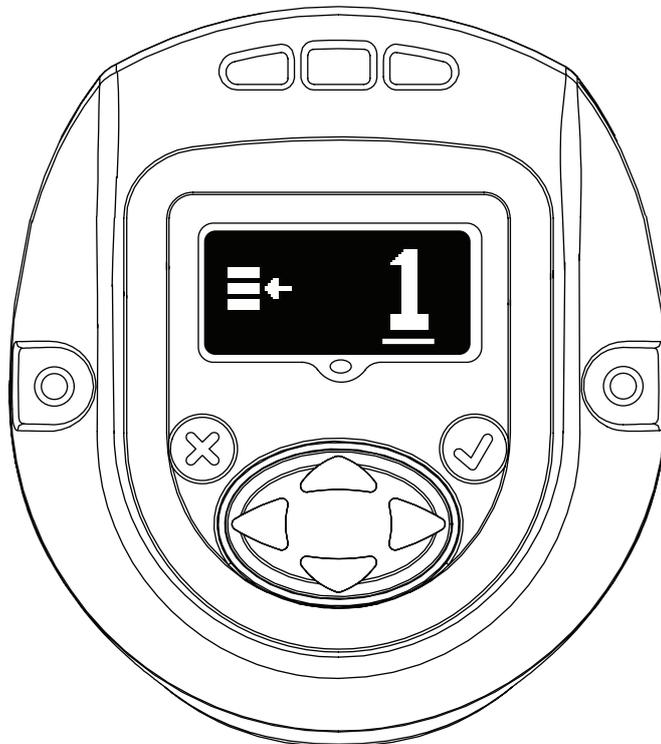
Les flèches "UP" ou "DOWN" peuvent être utilisées pour mettre à jour la configuration. Appuyer de nouveau sur "ENTER" sélectionnera la configuration modifiée.
