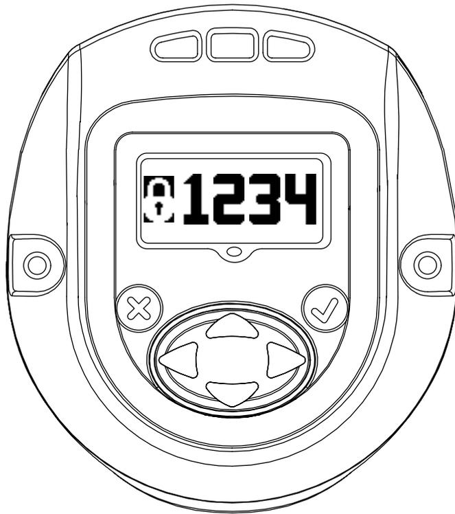
按“ENTER”进入“EDIT（编辑）”模式。输入正确的密码以解锁工具。按“ENTER”退出“EDIT（编辑）”模式。
