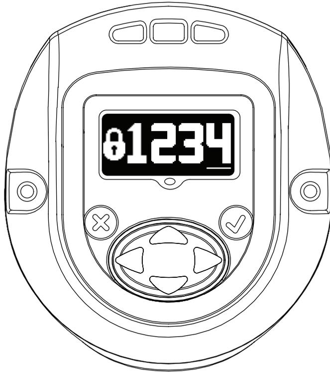
[Password (パスワード)] 画面に「1234」と入力されている場合、左矢印を使用して [Tool ID and software version (ツールIDとソフトウェアのバージョン)] ページを開きます。
