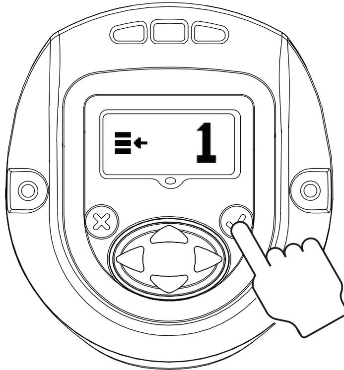
Durch Drücken von „EINGABE“ wird der „BEARBEITUNGSMODUS“ aktiviert. (Das Verfahren zum Aufrufen des „BEARBEITUNGSMODUS“ ist für alle Einstellungsaktualisierungen gleich)
