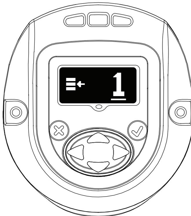
Mit den Tasten „NACH OBEN“ bzw. „NACH UNTEN“ können Sie die Konfiguration aktualisieren. Durch erneutes Drücken von „EINGABE“ wird die geänderte Konfiguration ausgewählt.
