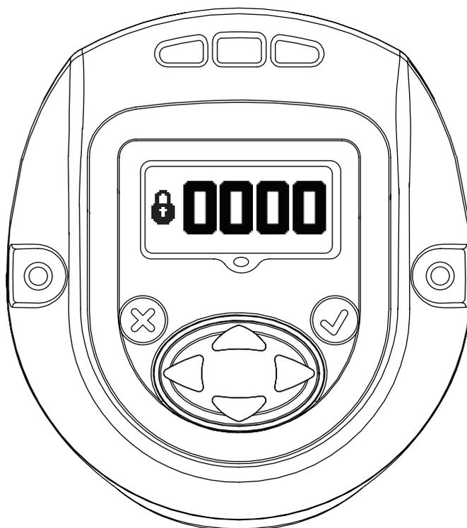
A Palavra-passe pode ser alterada entrando no modo "EDIT MODE" (modo de edição) e utilizando a tecla "UP" (Para cima) ou "DOWN" (para baixo).
