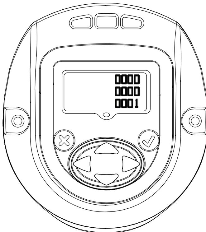
Norėdami grįžti į puslapį „Tool ID“ (Įrankio ID), dar kartą spauskite klavišą žemyn. Šiame puslapyje spustelėjus dešiniąją rodyklę, grįžtama į slaptažodžio ekraną.
