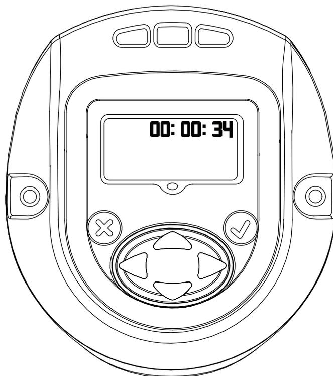
Часът на дисплея на инструмента е във формат ЧЧ:ММ:СС. Натиснете бутона надолу, за да се покаже часът на инструмента във формат ЧЧ:ММ:СС.
