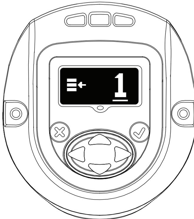
Met "OMHOOG" of "OMLAAG" kan configuratie worden bijgewerkt. Met "ENTER" wordt gewijzigde configuratie geselecteerd.
