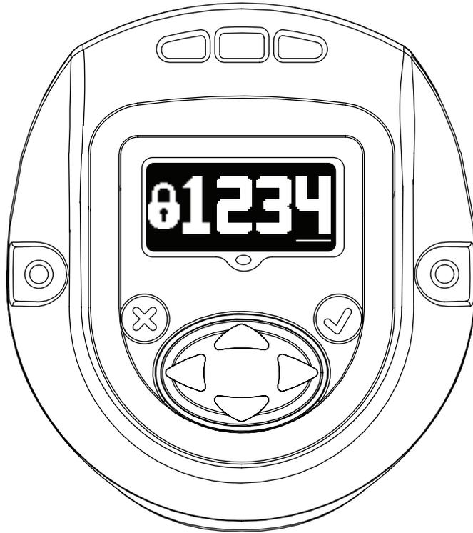
Si "1234" est saisi dans la fenêtre du mot de passe, l'utilisateur peut utiliser la flèche de gauche pour accéder à l'identifiant de l'outil et à la page de la version logicielle.
