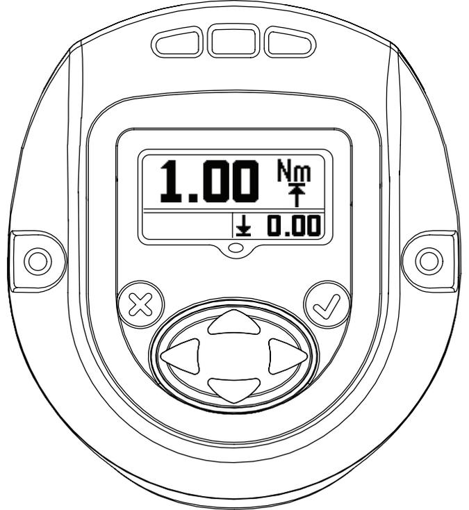
[Torque “TARGET”(トルク「目標」)] ディスプレイ
