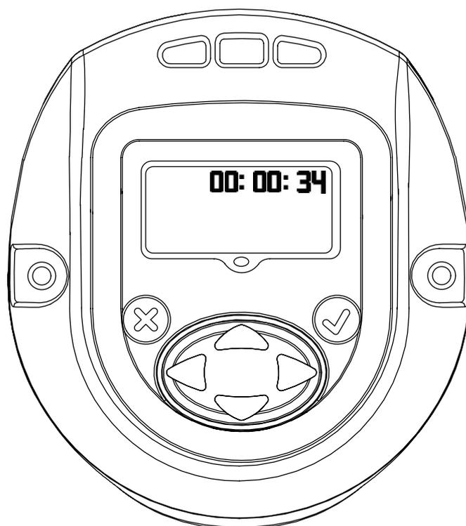
ツール稼働時間が HH:MM:SS 形式で表示されます。ツール稼働時間を HH:MM:SS 形式で表示するには [DOWN (下)] キーを押します。
