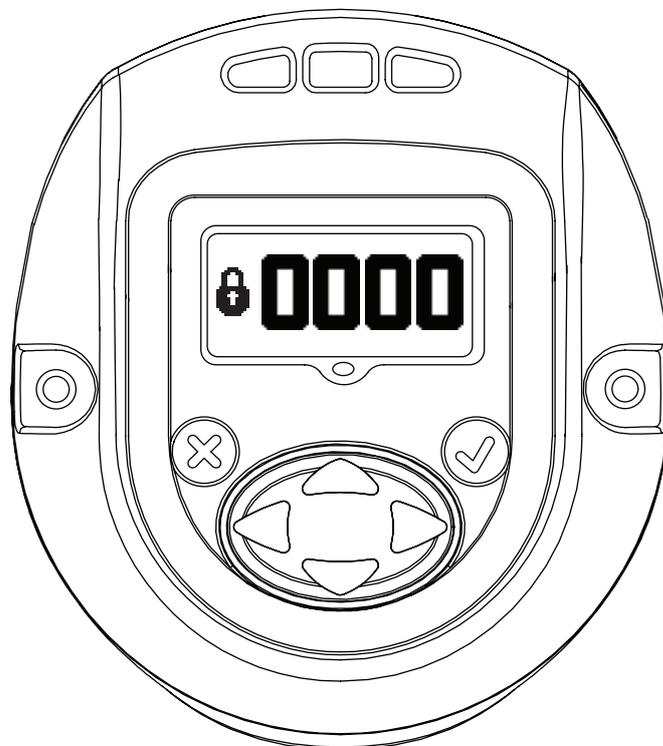
La contraseña puede modificarse accediendo al "MODO DE EDICIÓN" y utilizando las teclas "ARRIBA" o "ABAJO".
