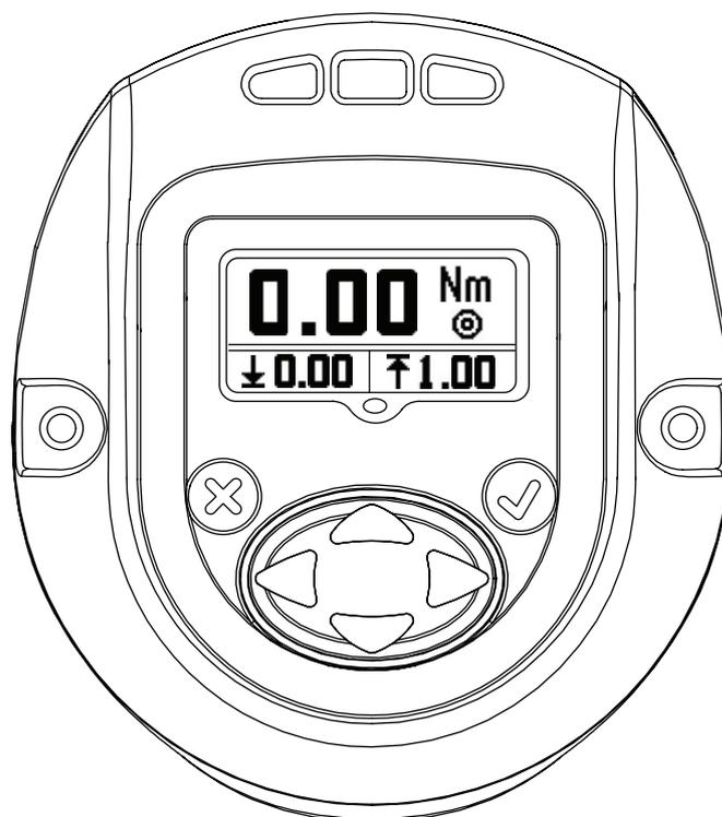
Naciśnięcie przycisku W GÓRĘ powoduje przejście z powrotem do EKRANU PRACA, pierwszego ekranu wyświetlacza.
