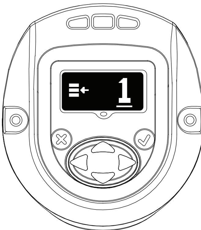
Tlačidlo „NAHOR“ alebo „NADOL“ je možné použiť na aktualizáciu konfigurácie. Opätovným stlačením tlačidla „ENTER“ sa zvolí zmenená konfigurácia.
