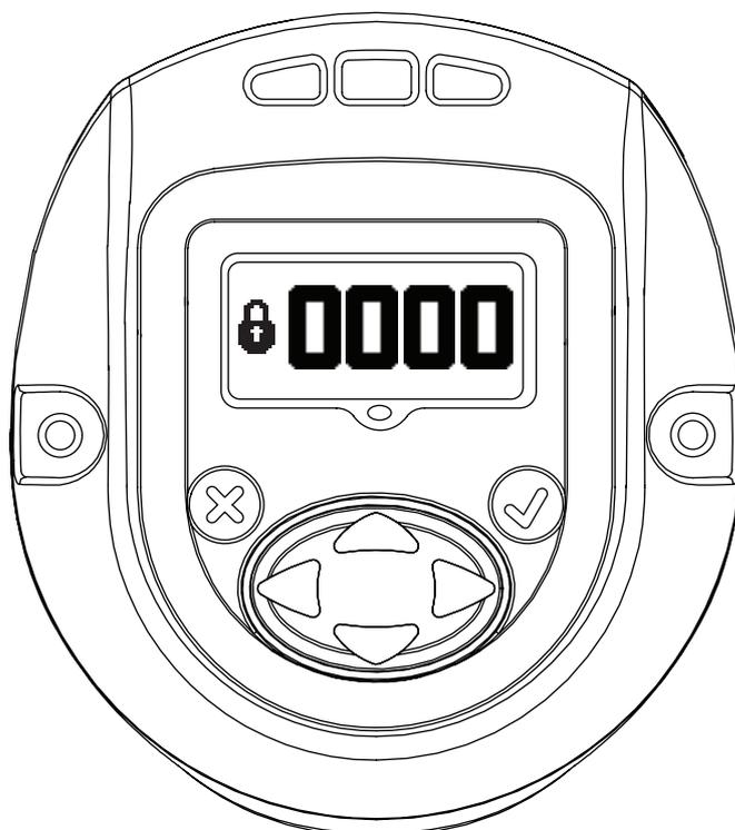
Heslo lze změnit po vyvolání „REŽIMU ÚPRAVY“ pomocí klávesy „NAHORU“ nebo „DOLŮ“.
