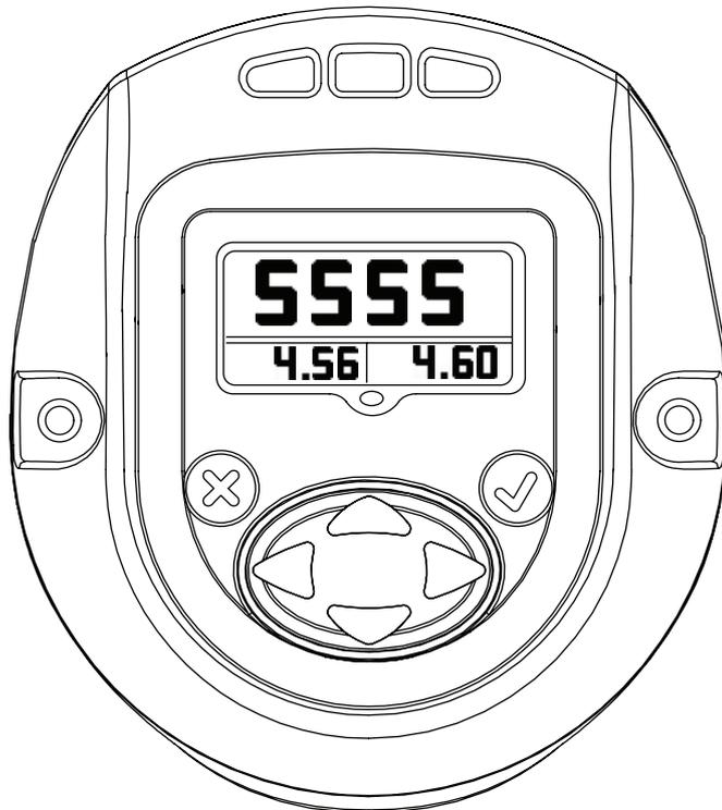
W głównej sekcji wyświetlacza jest wyświetlany identyfikator lokalizacji narzędzia.
