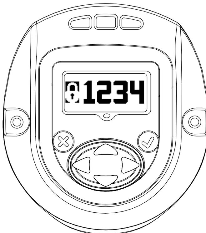
Tryk på "ENTER" for at gå ind i tilstanden "REDIGER". Indtast den relevante adgangskode for at låse værktøjet op. Tryk på "ENTER" for at gå ud af tilstanden "REDIGER".
