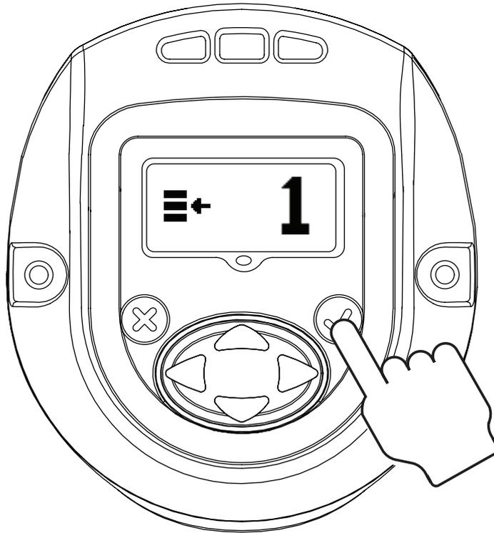
Appuyer sur "ENTER" activera le "EDIT MODE" (Mode de modification) (Cette procédure est identique pour la mise à jours de l'ensemble des paramètres)
