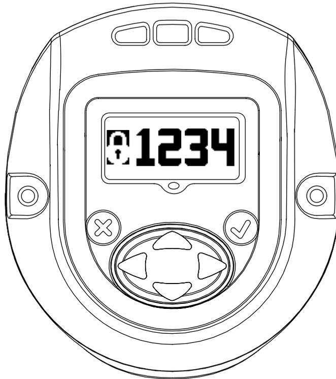
「編集」モードに切り替えるには、[ENTER] を押します。正しいパスワードを入力してツールのロックを解除します。
