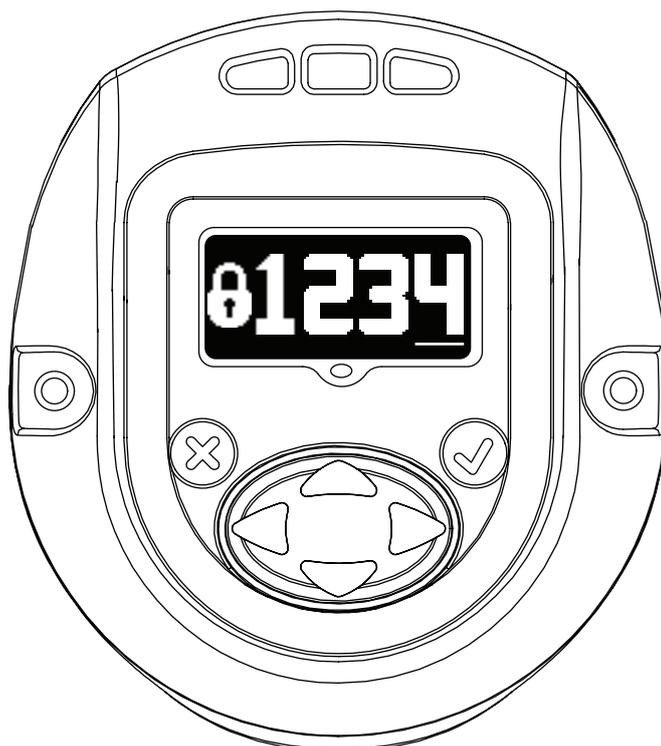
Se nella schermata della password viene inserito "1234", l'utente può utilizzare la freccia sinistra per passare alla pagina dell'ID utensile e della versione del software.
