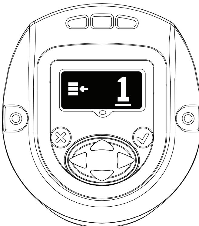
“OP”- eller “NED”-tasten kan bruges til at opdatere konfigurationen. Ved at trykke på “ENTER” igen vælges den ændrede konfiguration.
