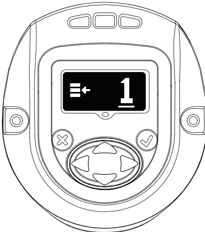
構成の更新には [UP (上)] または [DOWN (下)] キーを使用します。変更した更新を選択するには、再度 [ENTER] を押します。
