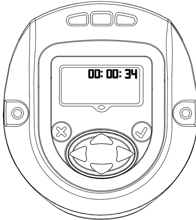
공구 시간을 HH:MM:SS 형식으로 표시합니다. 아래쪽 키를 눌러 공구 시간을 HH:MM:SS 형식으로 표시합니다.
