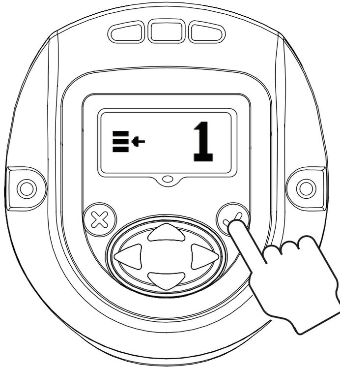
按“ENTER”将启用“EDIT MODE（编辑模式）”（这个进入“编辑模式”的程序与所有设置更新相同）
