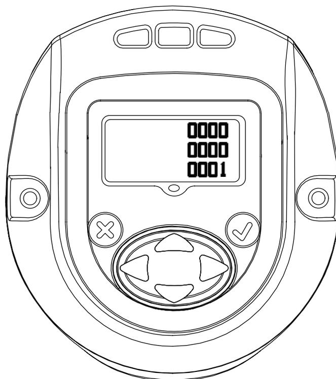
Naciśnij ponownie przycisk W DÓŁ, aby wrócić do strony identyfikatora narzędzia. Naciśnięcie na tej stronie strzałki w prawo spowoduje powrót do ekranu hasła.
