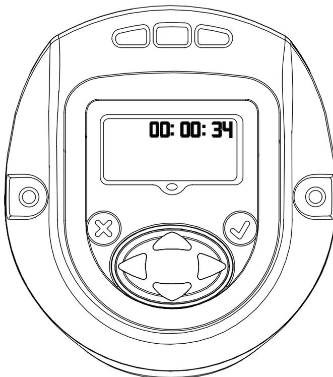
Megjeleníti szerszámidőt óó:mm:ss formátumban. Nyomja meg a Le billentyűt a szerszámidő óó:mm:ss formátumban való megjelenítéséhez.
