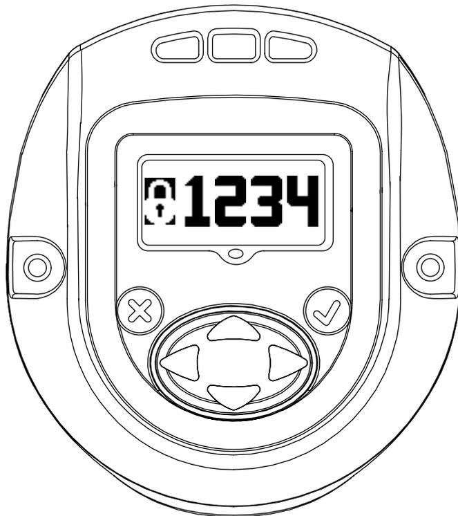
Druk op "ENTER" om modus "BEWERKEN" te openen. Voer het wachtwoord in om gereedschap te ontgrendelen. Druk op "ENTER" om modus "BEWERKEN" te verlaten.
