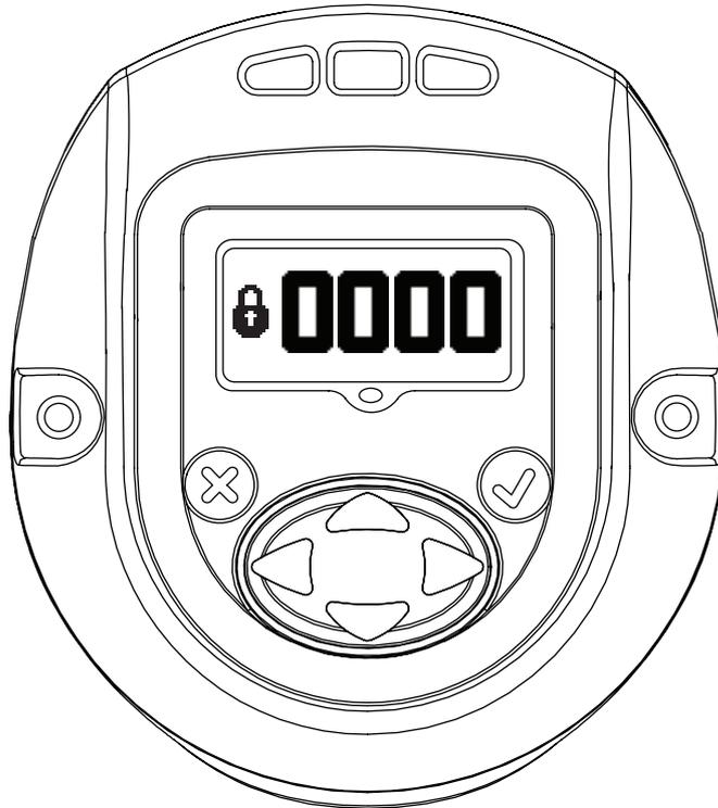
Le mot de passe peut être modifié en accédant au "EDIT MODE" et en utilisant les flèches "UP" ou "DOWN".
