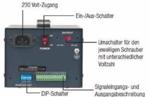
Die Sondersteuerungen S100 und S70 überwachen, ob das am Elektroschrauber eingestellte Abschaltmoment innerhalb eines einstellbaren Zeitfensters erreicht wird.
